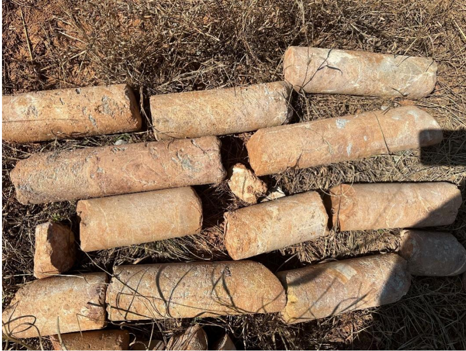
照 2.3-4 场地揭露石炭系下统大圪阶灰岩
